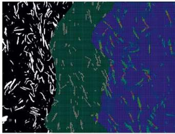
Schliffbild Diskretisierung Modellergebnisse Wärmestrom
