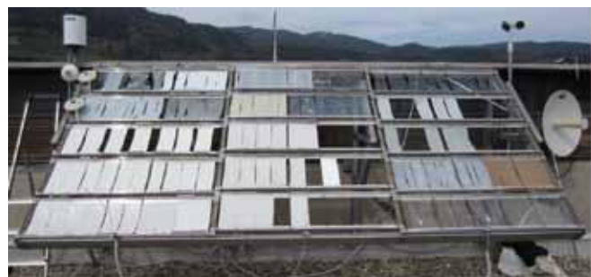
Abb. 2: Freibewitterungsstand auf dem Dach der Montanuniversität.
